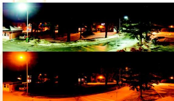
Fig. 2 - Iluminación con LED blancos (arriba) y ámbar (abajo).
