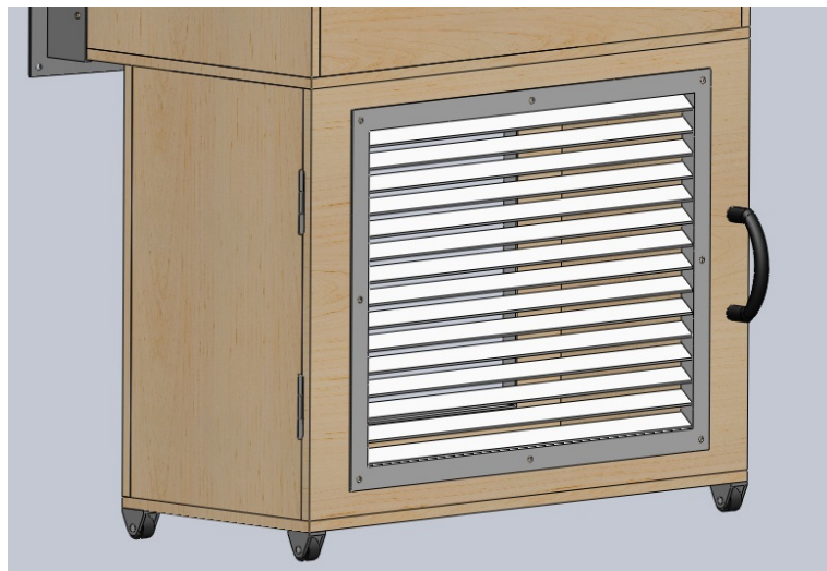
Figura 25: Compartimiento inferior de la caja de calefacción y aire acondicionado
