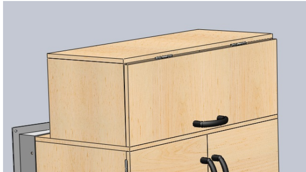
Figura 42: Compartimiento superior de la caja de control de show y extracción de aire.
