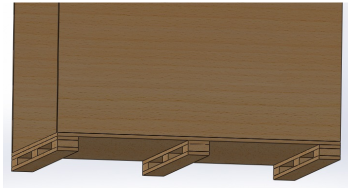
Figura 51: Plataforma para permitir el traslado de las cajas por medio de un autoelevador.
