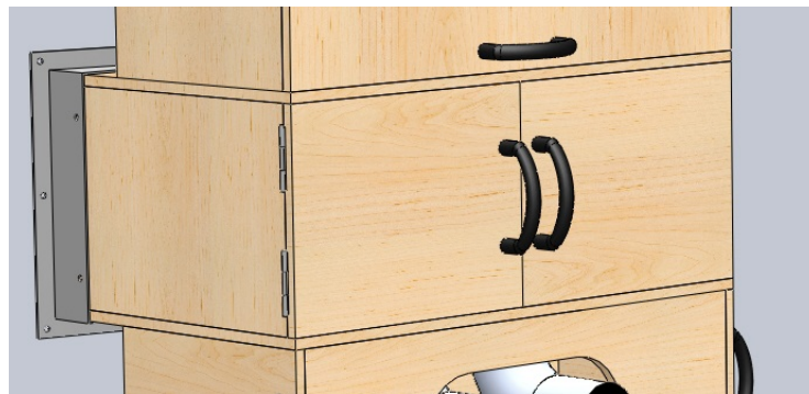
Figura 39: Compartimiento medio de la caja de control de show y extracción de aire, y vista de las puertas del mismo.
